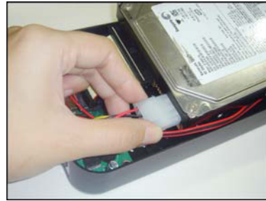
5. Подключите кабель питания к жесткому диску
