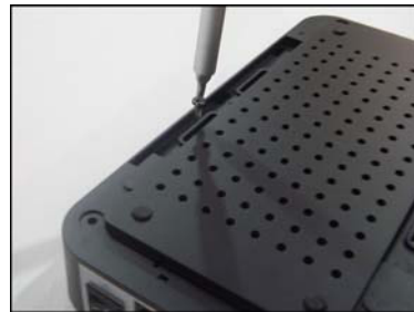
6. Надежно закрепите винты с нижней части корпуса для фиксации жесткого диска (4 коротких винта)
