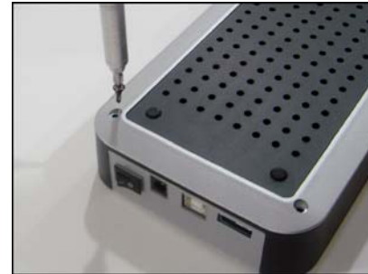
9. Используя два длинных и два коротких винта с нижней стороны накопителя, приверните крышку
