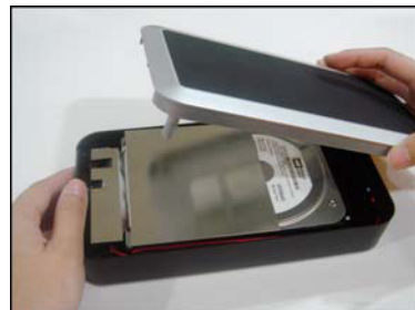
8. Закройте корпус внешнего накопителя крышкой
